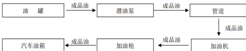
图 2.6.1-4 柴油加油工艺流程图
