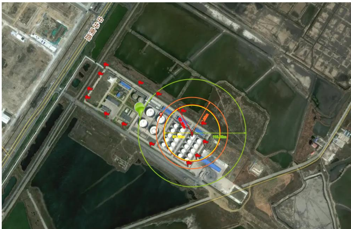
图 5-5 汽油储罐池火灾事故模拟
