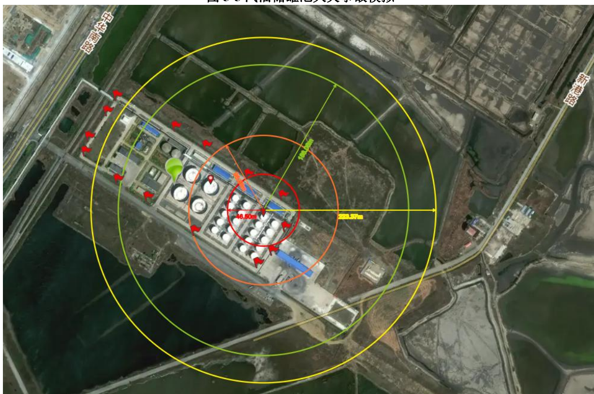
图 5-6 汽油储罐蒸汽云事故模拟
