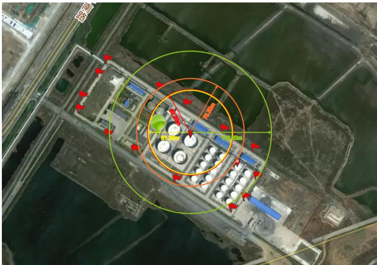
图 5-7 原油储罐池火灾事故模拟
