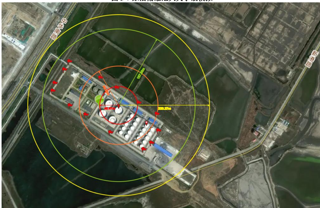
图 5-8 原油储罐蒸汽云事故模拟
