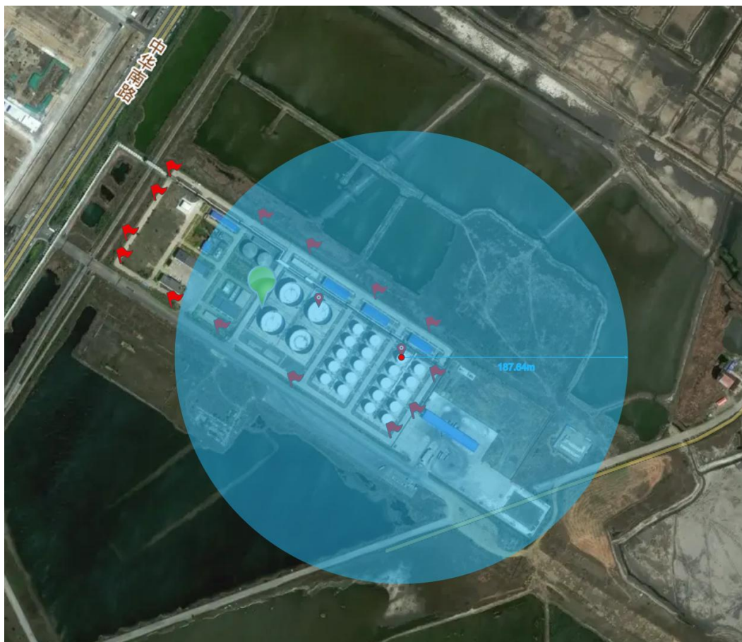
图 5-9 汽油储罐蒸汽云爆炸引起压力容器多米诺半径范围图
