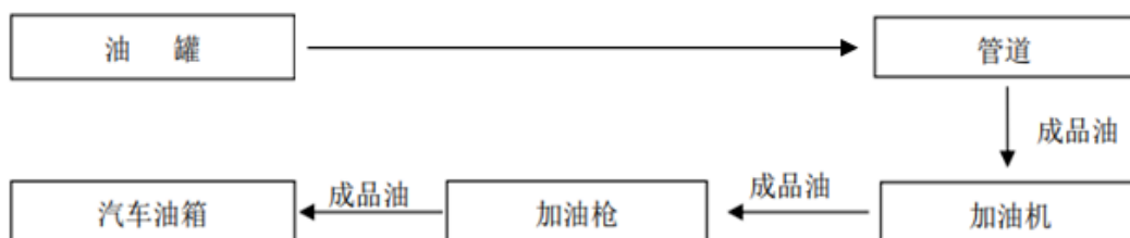
图 2.4.1-4 柴油加油工艺流程图
