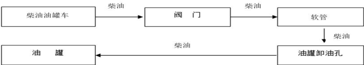
图 2.4.1-2 柴油罐车密闭卸油工艺流程图
