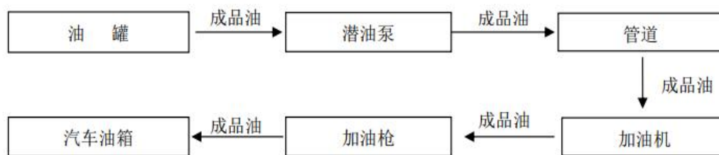
图 2.6.1-4 柴油加油工艺流程图
