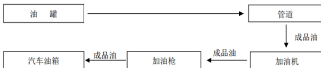
图 2.4.1-4 柴油加油工艺流程图
