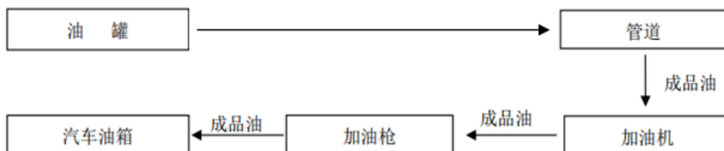
图 2.4.1-4 柴油加油工艺流程图
