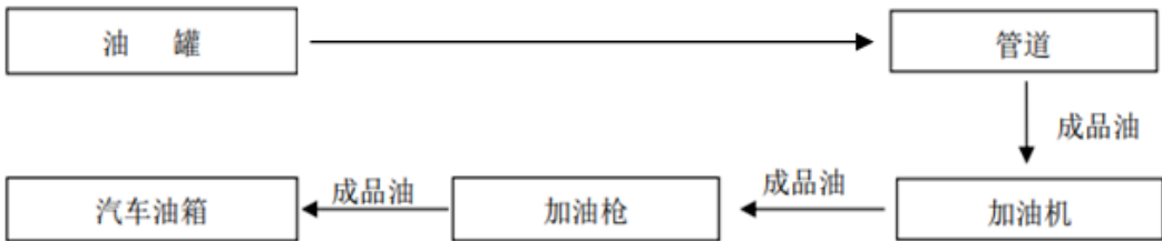
图 2.4.1-4 柴油加油工艺流程图
