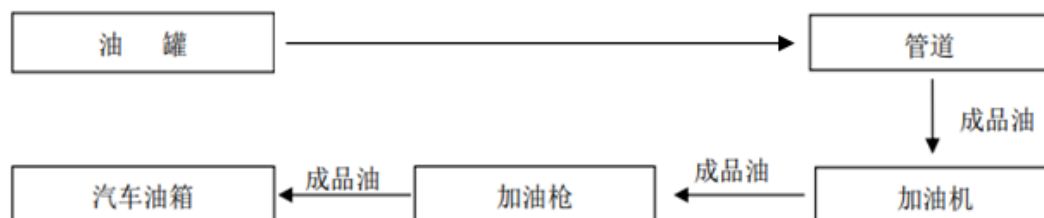
图 2.4.1-4 柴油加油工艺流程图
