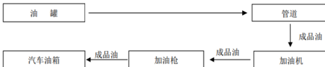
图 2.4.1-4 柴油加油工艺流程图
