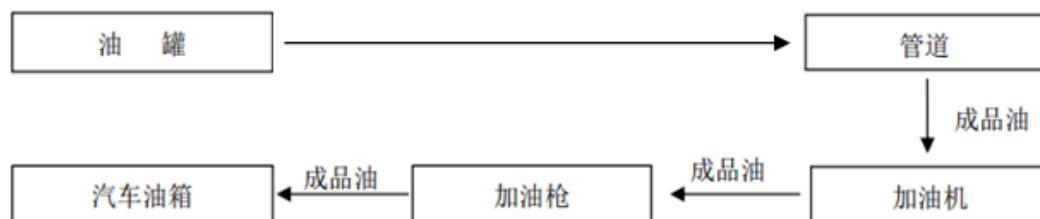
图 2.4.1-4 柴油加油工艺流程图
