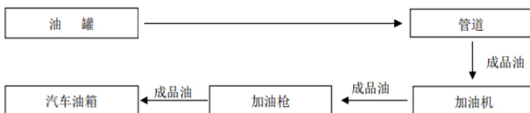
图 2.4.1-4 柴油加油工艺流程图
