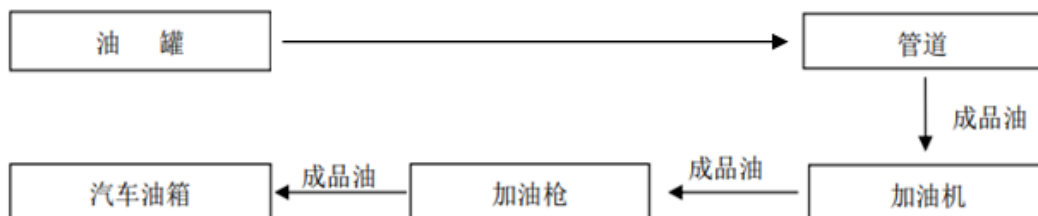
图 2.4.1-4 柴油加油工艺流程图
