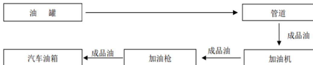
图 2.4.1-4 柴油加油工艺流程图
