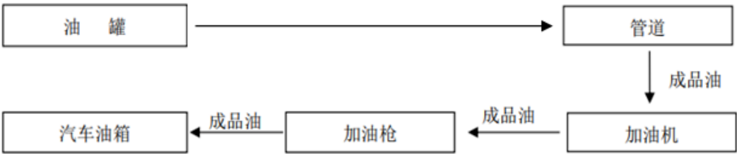
图 2.4.1-4 柴油加油工艺流程图
