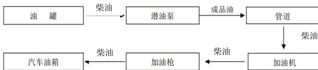
图 2.4.1-4 柴油加油工艺流程图
