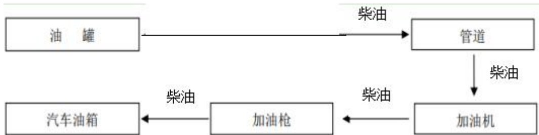
图 2.4.1-4 柴油加油工艺流程图
