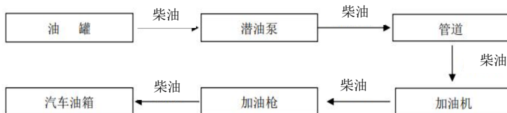
图 2.4.1-4 柴油加油工艺流程图
