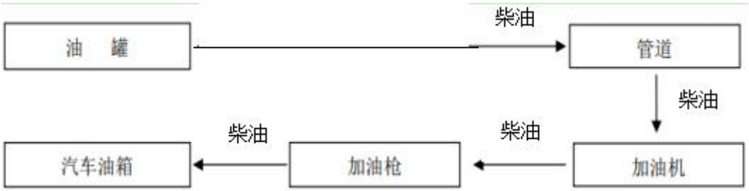
图 2. 4. 1-4 柴油加油工艺流程图
