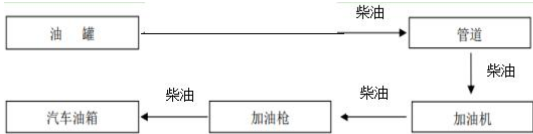
图 2.4.1-4 柴油加油工艺流程图
